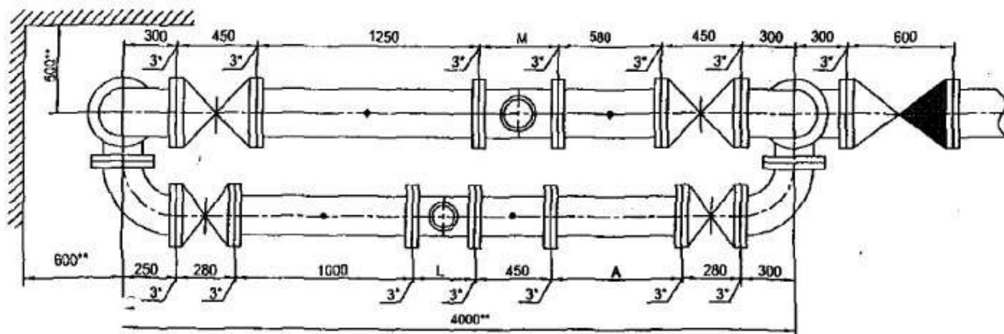
Установка счетчика  $du=200$  мм на хозяйственно-питьевой линии и счетчика  $du=250$  мм на пожарно-резервной линии в водомерном узле на вводе диаметром 250 мм.
