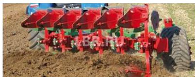
**VIS XL** - плуги с рамой 180×180×8 мм с отвалом ZX и шириной захвата до 48 см на корпус, версии **от 6 до 8 корпусов** с шириной 100 см между корпусами.
