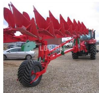
9. Для агрегатирования с тракторами К 700 и Т 150 плуг должен быть укомплектован специальным передним опорным колесом.
