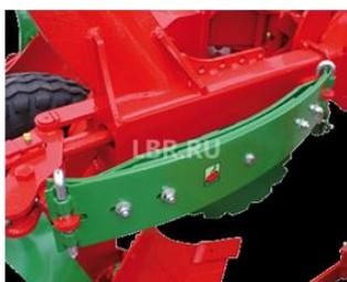
Автоматизированная защита на базе стальных листовых рессор, благодаря которым становится возможным эффективное отклонение корпуса в случае столкновения лемеха с препятствием 1300 кг и возвращение в рабочее положение после преодоления препятствий
