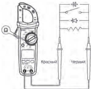
Рис. 4 Измерение сопротивления, проверка целостности, диода, измерение ёмкости
