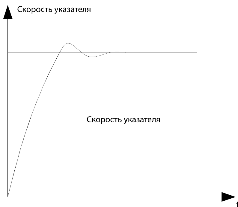
Кривая переходного процесса с хорошими динамическими характеристиками
