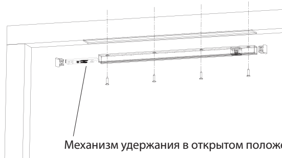
Рис. 2. Установить и зафиксировать направляющий профиль тяги
