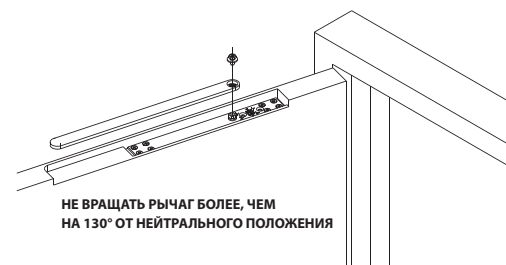
Рис. 3. Присоединить рычаг к оси доводчика
