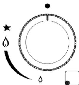
Модель KG 026 S оснащена ступенчатой регулировкой пламени и электроподжигом. Чтобы включить одну из конфорок, необходимо нажать ручку до упора, повернуть ее против часовой стрелки в положение "6" и удерживать нажатой в течение примерно 6 секунд, чтобы прогрелась термопара. Затем отрегулируйте пламя, как вам необходимо. В случае сбоя электропитания конфорки можно также разжечь с помощью спичек.
