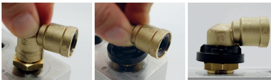
4. Сборка поворотного фитинга завершена и можно подсоединять трубопровод. Корпус может быть повернут в необходимом положении (поворот на 360°). Если вы установили анти-проворотное кольцо и не опустили его вниз, то корпус фитинга может вращаться.
