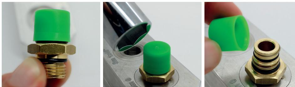
2. Установите корпус фитинга на резьбовой шарнир. Если вы хотите заблокировать вращение фитинга, то используйте анти-проворотное кольцо. Установите анти-проворотное кольцо на корпус фитинга, перед установкой его на шарнир, затем установите корпус на резьбовой шарнир.
