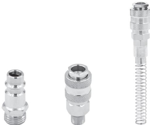
Самозапирающиеся быстроразъемные соединения – куплунги – применяются для подключения и отключения переносного пневматического инструмента и приспособлений к магистрали сжатого воздуха, без отключения давления. Это экономит значительное количество времени.
