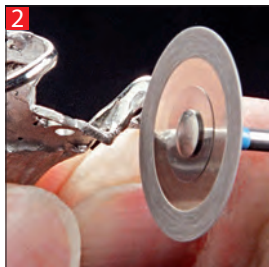
2 Обработка металлических каркасов. Trimming of metal framework.
