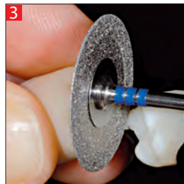
3 Обрезание литников. Separation of press sprues.
