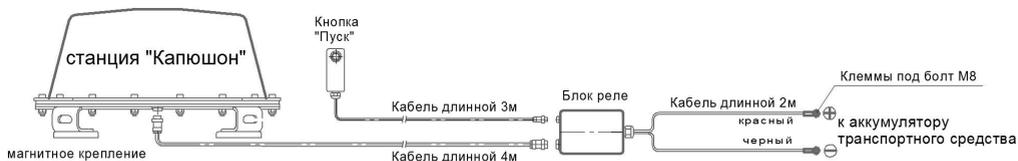
Схема установки станции "Капюшон" на бронетехнику с напряжением бортовой сети 24В
