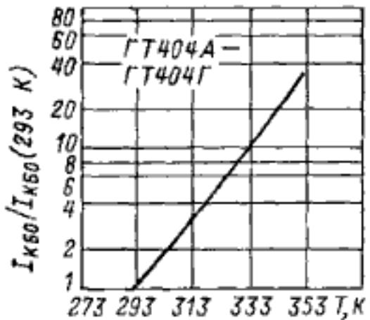
Зависимость относительного обратного тока коллектора от температуры.
