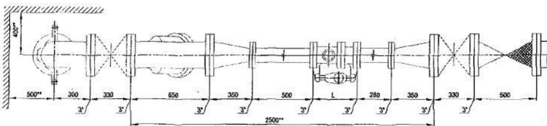
Установка комбинированного счетчика с диаметром основного канала  $D_y=100$  мм
