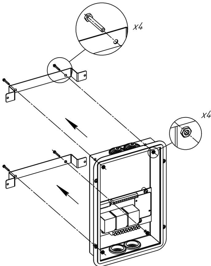
**2.** Установить заднюю часть блока (16) в проем стены и закрепить через ушки кронштейна (14) к стене с помощью саморезов (19).
