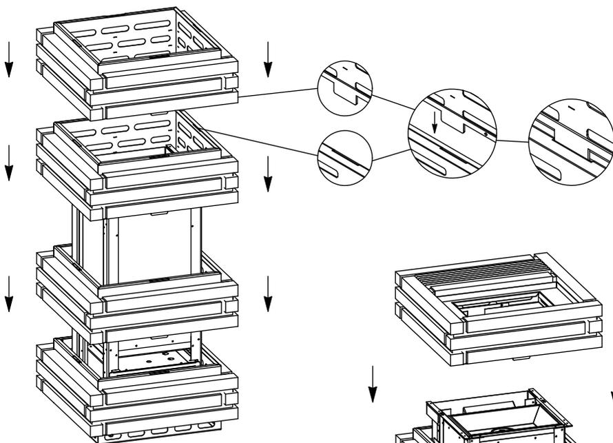
**3.** Установить верхний модуль (13.1), совмещая соответствующие четыре пластины на каждом модуле с пазами на предыдущем, при этом декоративная решетка должна располагаться над конвекционным каналом.
