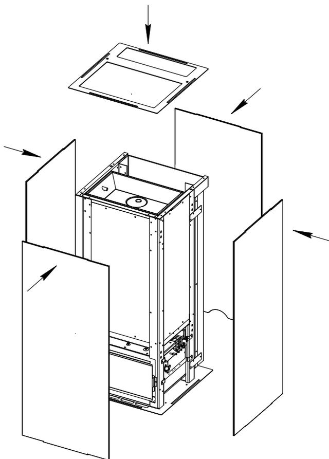
**3.** Установить монтажную рамку (5), совместив пазы на рамке с шипами на панелях (12.1-12.3), установить верхнюю панель (12.4) и закрутить винты (7), предварительно установив фторопластовые прокладки под головки винтов.
