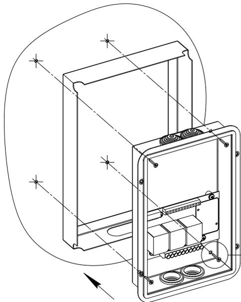
**1.** Перед установкой необходимо разметить места крепления блока управления на стене, выбрать с какой стороны будет вывод кабеля. Вложить заднюю часть блока (16) в корпус блока (18), предварительно расположив отверстие на корпусе (18) с той стороны, откуда будет вывод кабеля, и установить на стену при помощи саморезов (19).
