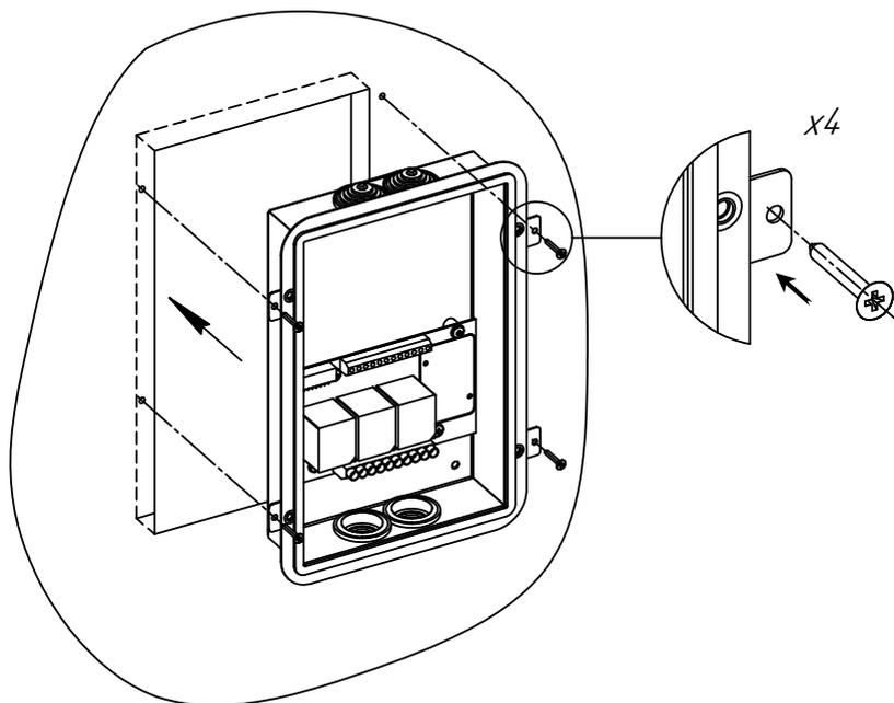
**3.** Приложить переднюю часть блока (17) к задней (16), подключить шлейф к разъему. Совместить отверстия на передней (17) и задней (16) части блока и закрепить между собой при помощи крепежа (20).
