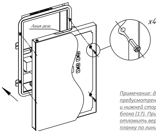
*Примечание: для вывода кабеля предусмотрены выемки на верхней и нижней стороне передней части блока (17). При необходимости отломить верхнюю либо нижнюю планку по линии реза.*
