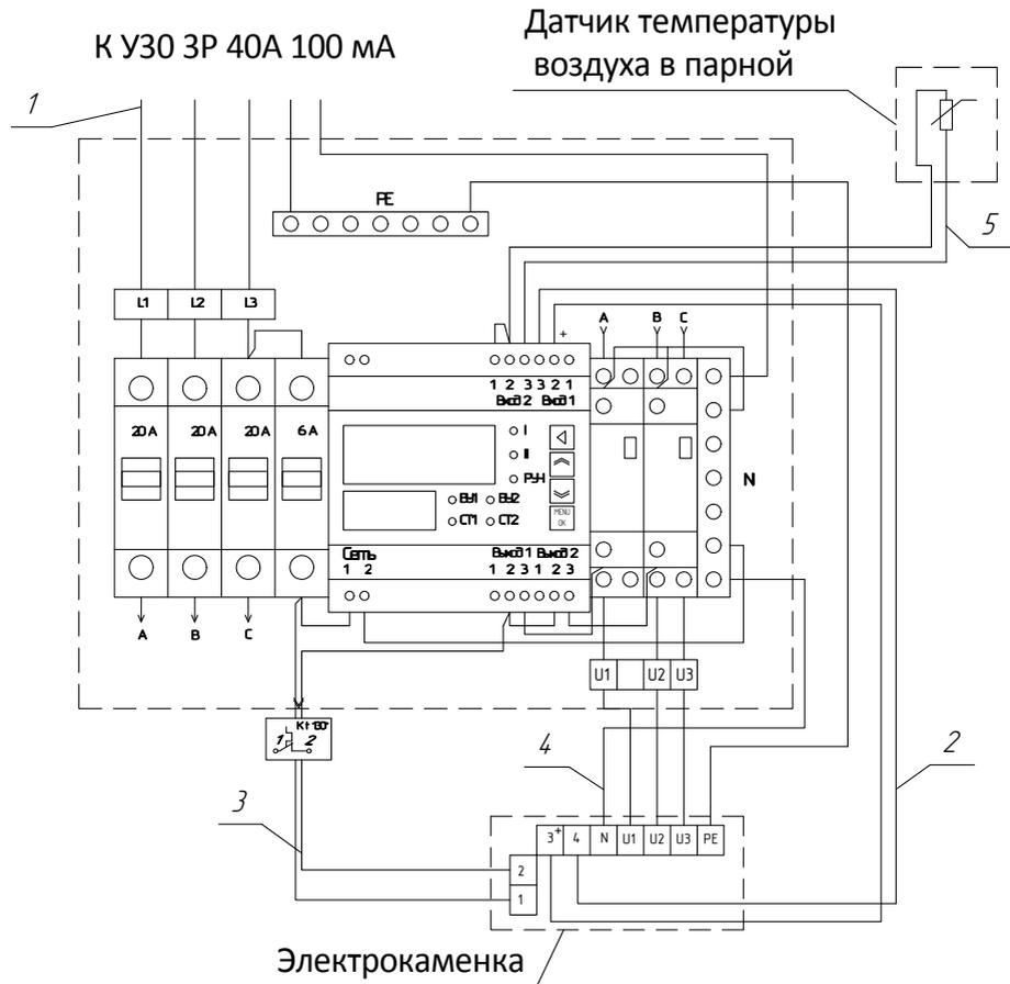
1. Кабель с медными жилами сечением  $5 \times 2,5 \text{ мм}^2$ .
