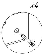
**2.** Приложить переднюю часть блока (17) к задней (16), подключить шлейф к разъему. Совместить отверстия на передней (17) и задней (16) части блока и закрепить между собой при помощи крепежа (20).
