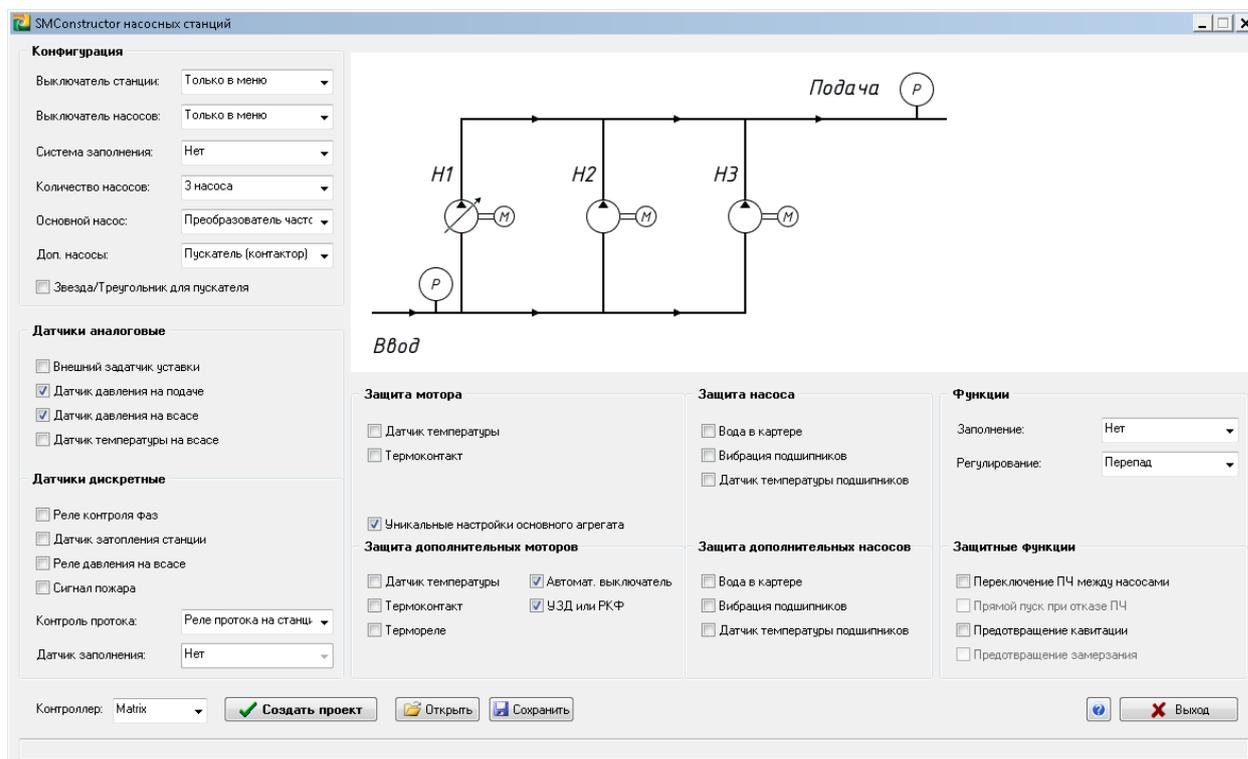
Функции и устройства, входящие в насосную станцию, выделены в группы: общая конфигурация, датчики для регулирования, датчики для защиты, настройки защиты насосов. Отдельно вынесены функции, доступные при том или ином составе выбранного оборудования.
