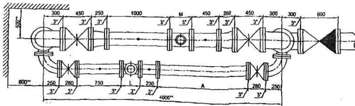
Установка счетчика  $\text{ф} = 150$  мм на хозяйствственно-питьевой линии и счетчика  $\text{ф} = 200$  мм на пожарно-резервной линии в водомерном узле на вводе диаметром 250 мм.
