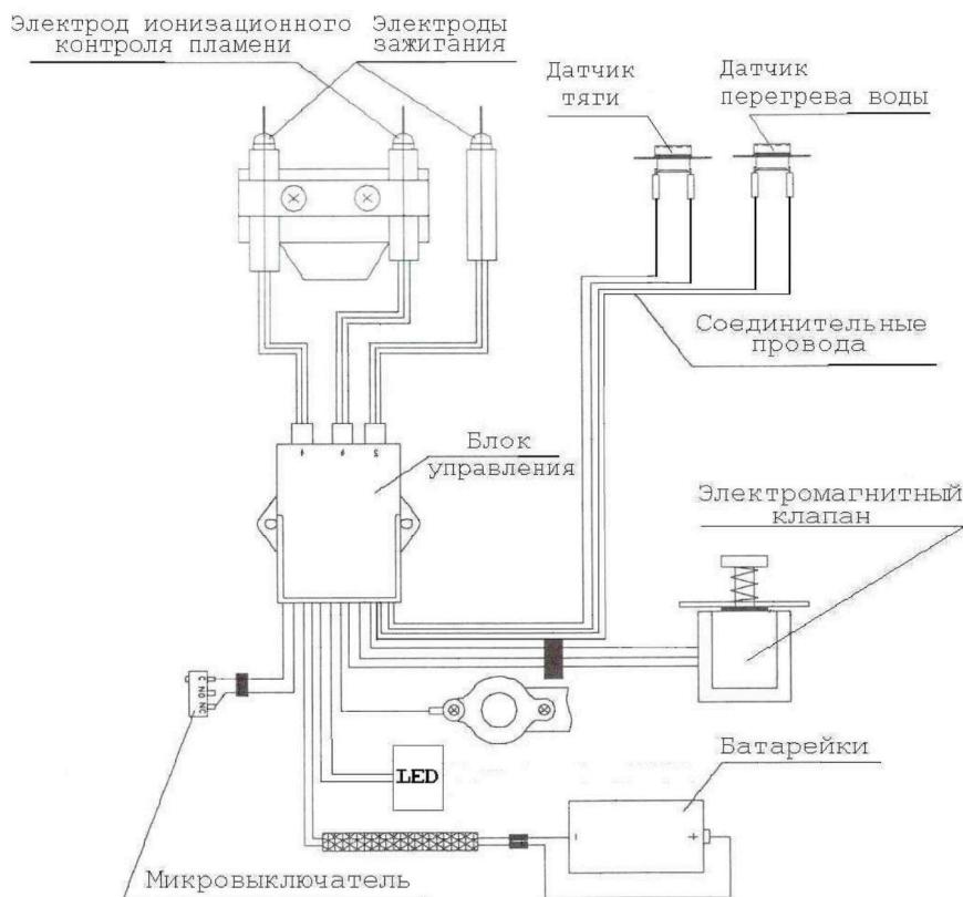
Рис.2. Схема электрическая
