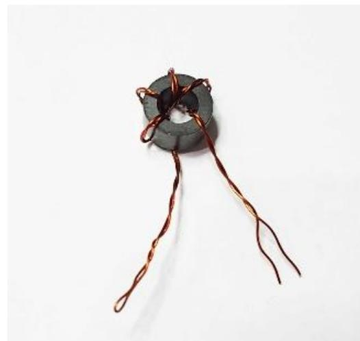
Шаг 4. Аккуратно снять лаковую изоляцию с концов проводов и с помощью мультиметра определить концы проводов.
