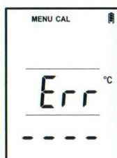
9. Нажатие на кнопку [ESC/Recall] возвращает дисплей на шаг назад. Режим калибровки / режим Menu, затем обычный режим. (Если показания нестабильны или электрод не подключен к тестеру, на дисплее появится сигнал "Err" и будет мигать 3 раза, а затем вернется в меню калибровки.)
