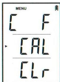
Калибровка требуется при замене электрода или после длительного хранения, чтобы обеспечить точные показания. Сначала калибруйте pH 7.00, а затем pH 4.00 или pH 10.00, в зависимости от диапазона измерений.
