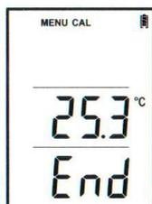
8. Сигнал "End" будет мигать трижды на дисплее, тестер вернется в режим калибровки. Калибровка закончена.
