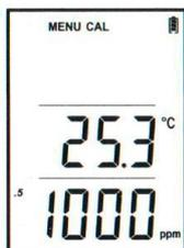
6. После стабилизации показаний нажимайте кнопки [UP/MENU] или [DOWN/UNIT] для корректировки результата измерения до нужного значения калибровки. ВНИМАНИЕ: При нажатии и удержании кнопки изменения будут быстрее.
