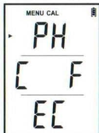
3. Режим CAL отобразит на экране "PH", "C F" и "EC". Выберите "PH" нажатием на кнопку [STORE/ENTER] для входа в режим калибровки pH.
