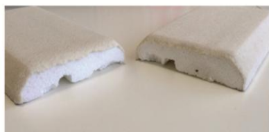
Фабричный стык (так изделие сходит со станка)
