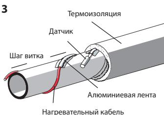
Существует несколько способов установки нагревательного кабеля на поверхность трубы. Один или несколько кабелей укладывают по прямой линии вдоль трубы (**рис. 1**). Кабель укладывают на трубе волнистой линией или оборачивают спиралью (**рис. 2, 3**). Определить приблизительный шаг витков кабеля после расчета необходимой длины на 1 погонный метр трубы можно по формуле:
