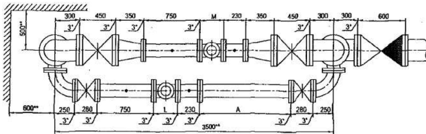
Установка счетчика  $d_u=150$  мм на хозяйственно-питьевой линии и счетчика  $d_u=150$  мм на пожарно-резервной линии в водомерном узле на вводе диаметром 250 мм.
