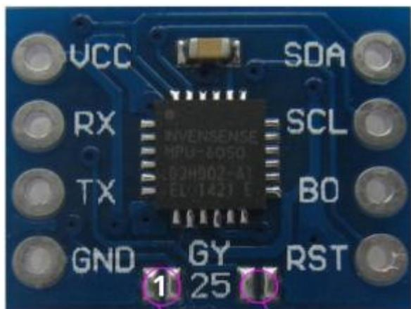
GY25 - это датчик IMU с выходными данными в виде крена, шага и рыскания (подробнее). В этой главе описывается процесс доступа к данным GY25 с помощью Arduino Mega. Скорость передачи GY25 составляет 115200 без перемычки 1, на плате GY25.
