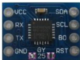
GY25-это датчик аналогичный датчикам IMU. Как и датчик imu в целом, в датчике есть датчик ускорения и гироскоп. Разница gy25 с датчиками imu в наличии мощного ARM микроконтроллера, который имеет встроенную программу предварительной обработки данных так, что выход этого датчика готов к использованию без необходимости проведения калмановской фильтрации для всех данных по крену, тангажу и рысканью. Параметр рыскание используется для замены датчика компаса.
