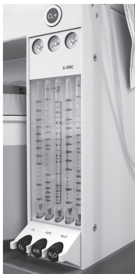
Рис. 3.2. Ротаметрический дозиметр наркозного аппарата.
