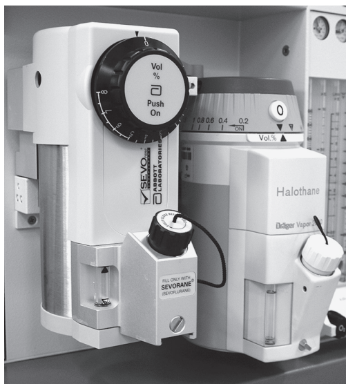
Рис. 3.3. Испаритель жидких анестетиков.
