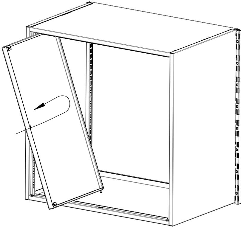
*1. Дверь сначала устанавливается в нижнюю прорезь.*
