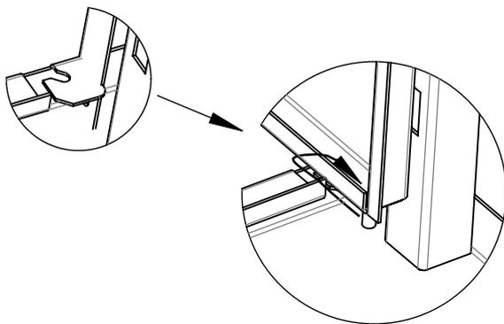
*2. Затем в верхнюю прорезь. С усилием вывести дверь в верхней части в вертикальное положение (до глухого щелчка)*
