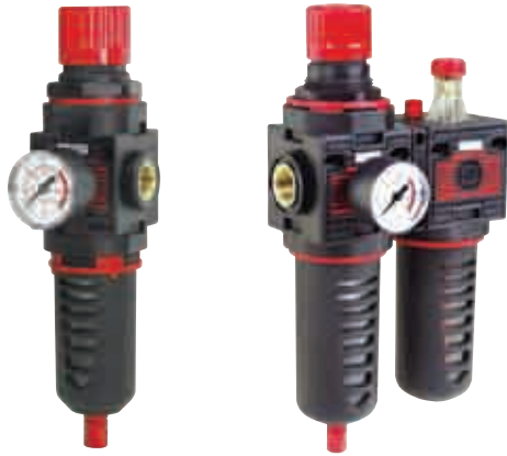
Фильтр-влажномаслоотделитель со встроенным регулятором давления (слева) и фильтр-влажномаслоотделитель с лубрикатором
