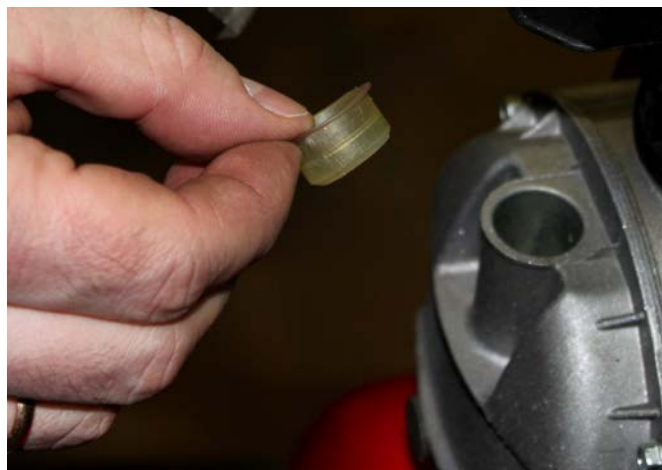
На некоторых моделях контроль уровня масла осуществляется при помощи щупа
