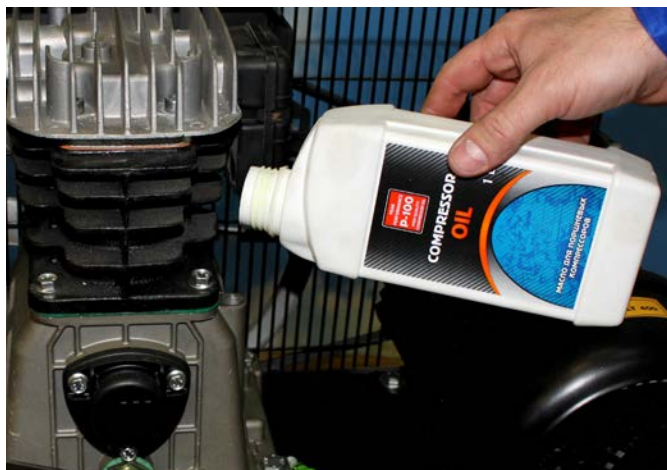
Замена компрессорного масла
