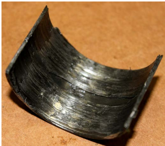
Отсутствие смазки привело к появлению задиров на вкладыше
