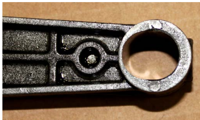
Износ втулки верхней головки шатуна
