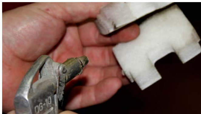
Демонтаж воздушного фильтра и очистка его картриджа
