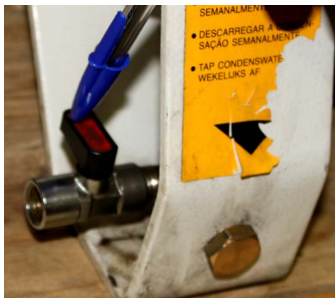
Удаление конденсата из ресивера
