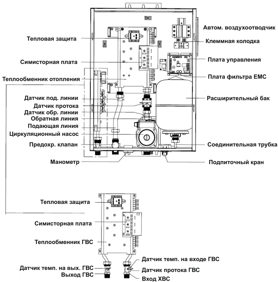
Рис. 2. Схема внутреннего устройства изделия
