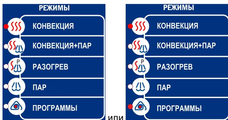
При включении пароконвектомата напротив надписи с названием режима загорается светодиод – работа по режиму. А если после включения пароконвектомата в поле режимы одновременно загорается светодиод одного из четырех режимов и светодиодом «Программы» (см. правый рисунок) это свидетельствует, что работа пароконвектомата будет выполняться по ранее сохраненным программам с установленными режимами и параметрами (см. п. Приготовление с использованием режима «Программа»).
