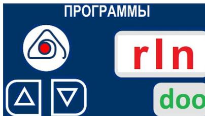
Закройте дверь пароконвектомата. После закрытия двери мойка включается по заданному алгоритму.
