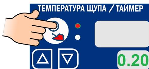
На панели управления пароконвектомата нажмите и удерживайте кнопку параметра «Таймер» более 3с.
