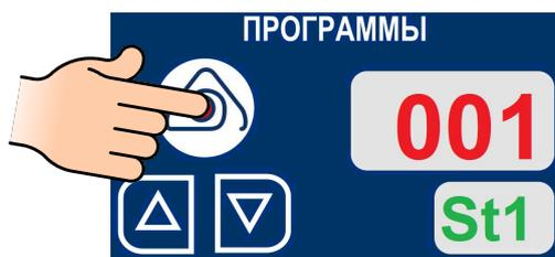
Символ «**St1**» начинает мигать. Для создания многошаговой программы доступны режимы «**Конвекция**» и «**Конвекция+Пар**». Режим «**Разогрев**» не доступен.
