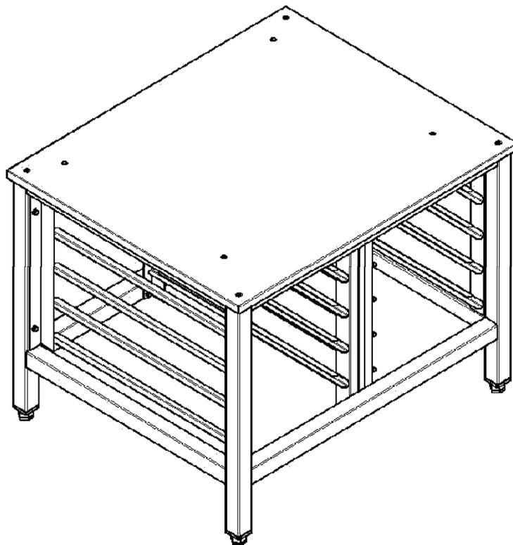
Рис. 18 Подставка для пароконвектоматов ПК-6М и ПК-10М
