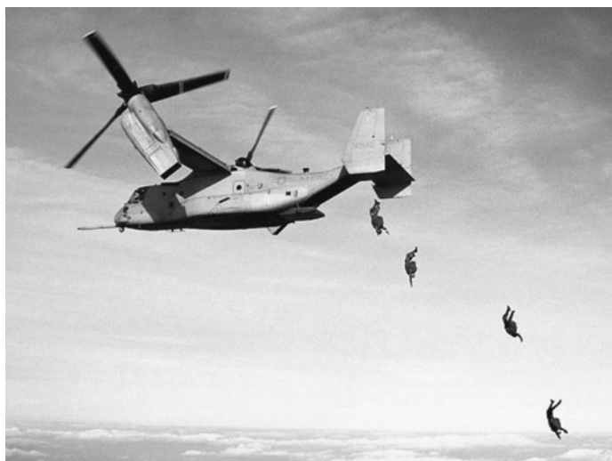
РИСУНОК 55-1. Конвертоплан VР22 «Osprey» (англ. скопа) позволяет транспортировать десант и припасы на значительные расстояния. Он может приземляться и взлетать вертикально, как вертолет, а также летать по прямой, как самолет.
