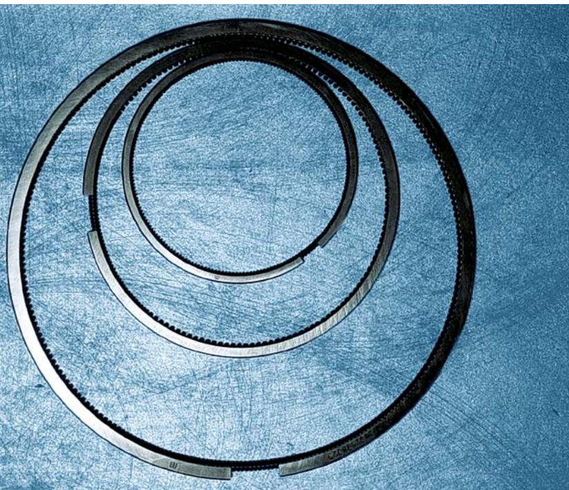
Для установки поршневых колец требуется особая осторожность. Любое ненужное снятие и повторное надевание на поршень с чрезмерным разжиманием приводит к образованию неисчезающих деформаций и отрицательно сказывается на рабочих характеристиках колец.
