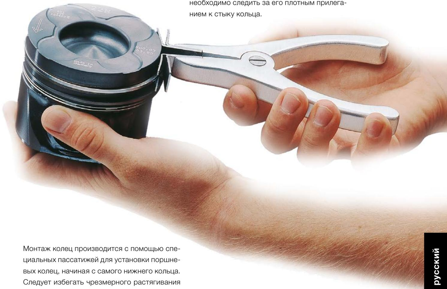
Монтаж колец производится с помощью специальных пассатижей для установки поршневых колец, начиная с самого нижнего кольца. Следует избегать чрезмерного растягивания колец, поскольку они при этом деформируются и теряют способность к надёжной герметизации. При этом необходимо обращать внимание на маркировку «TOP» на кольце. Кольца с маркировкой «TOP» устанавливаются этой маркировкой вверх в направлении дна поршня.
