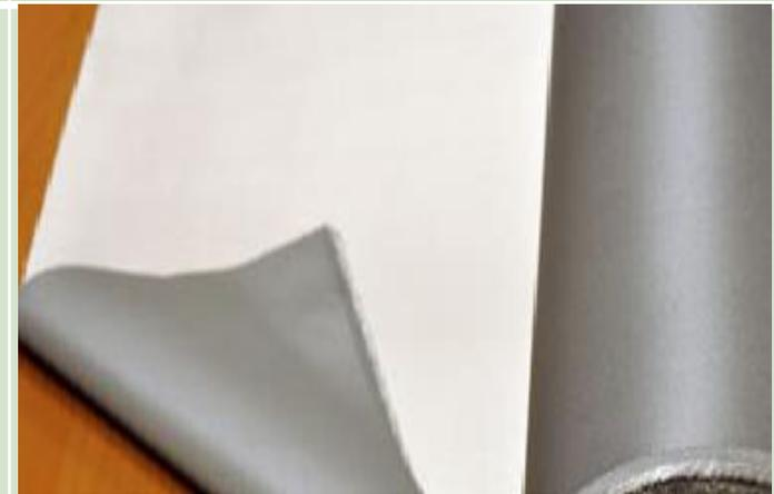
Ткань кремнеземная с полиуретановой пропиткой серого цвета, переплетение сатиновое. Может быть с двух сторон с ПУ. Используется при производстве противопожарных и дымозащитных штор, вибровставок в воздуховодах и т.д.
