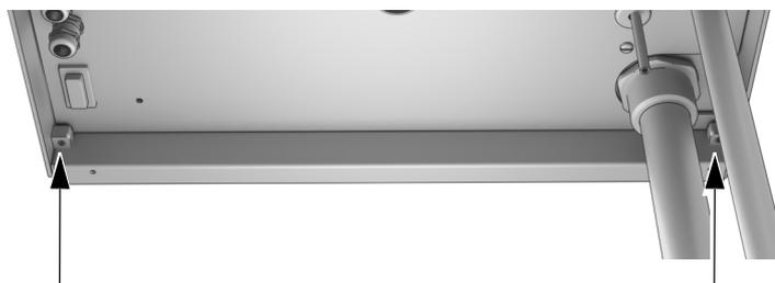
☒ Привинчивание кожуха корпуса
