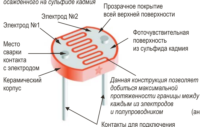
Рис. S10.1. Устройство фоторезистора (слева) и модуль KY-018 (справа)
