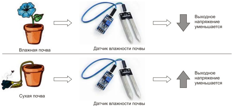
Рис. S5.2. Принцип работы датчика влажности почвы
