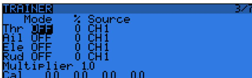
Эта страница позволяет вам настроить функцию тренера для использования передатчика в качестве "master" (убедитесь, что режим Trainer в настройках модели установлен в Master). Для каждой из 4 основных функций вы можете установить режим ("OFF", "+=" для добавления, ":-" для замещения), коэффициент и входной канал.
