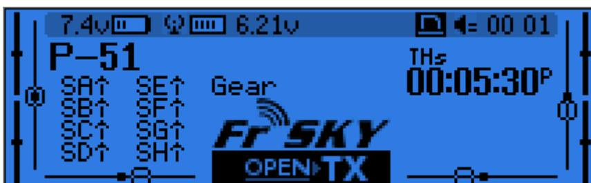
Второй экран отображает джойстики и положения переключателей, и удобен для проверки того, что все физические органы управления работают как предназначено.
