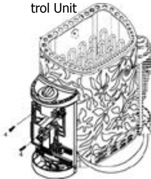
Рис. 5B | Перестановка встроенного блока управления Fig. 5B | Repositioning the Built-in-Con- trol Unit
