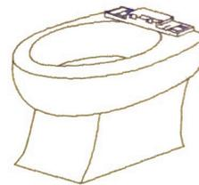
2. Отрегулируйте положение Крепежной рамы и Вставок, слегка затяните Гайки на Установочных болтах.
