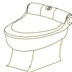
2. Отрегулируйте положение Вставок в Крепежной раме и положение Изделия на унитазе. Затяните Гайки на Установочных болтах (Не применяйте чрезмерное усилие).
