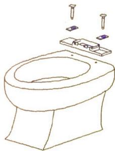
1. Если требуется, демонтируйте с унитаза другое сидение. Установите на унитаз Крепежную раму, оденьте на Установочные болты по одной Вставке и вставьте Установочные болты в крепежные отверстия унитаза.
