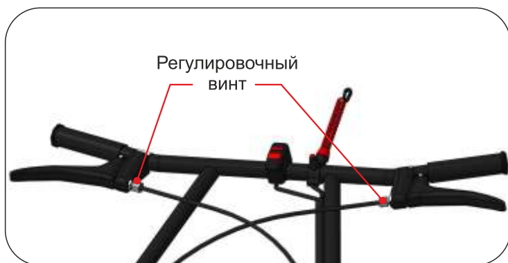
Рис. 18. Регулировка дросселя заслонки газа и натяжки тормозной ленты.
