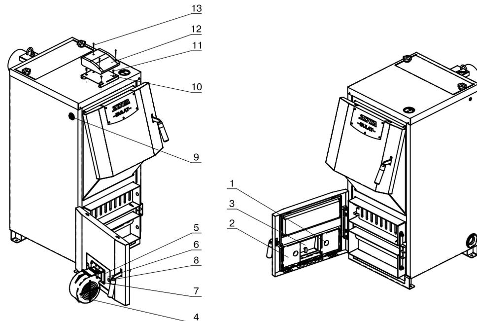
Рис.3. Установка комплекта TurboSet на котлы Zota Bulat
