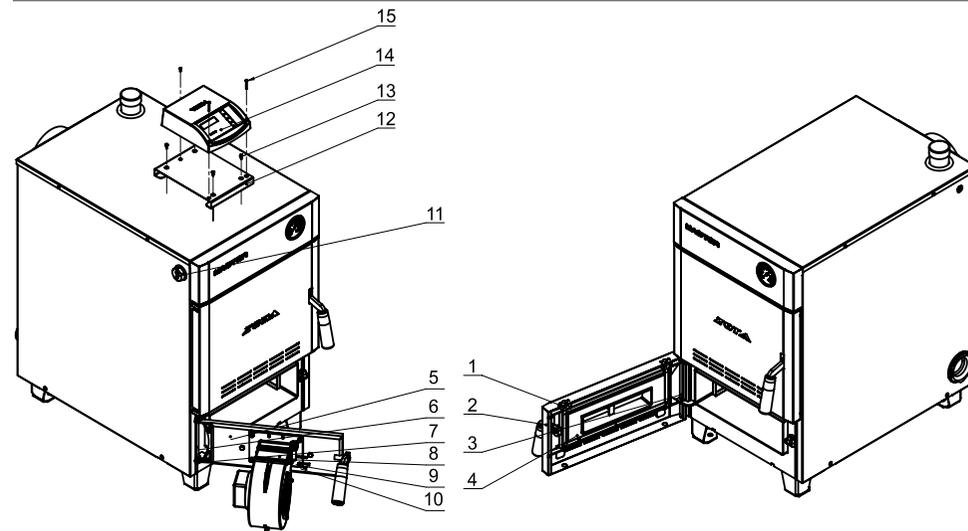
Рис.2. Установка комплекта TurboSet на котел Zota Master 14;20
