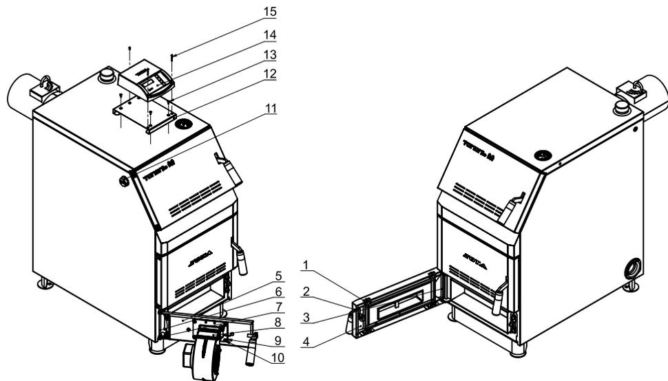
Рис.1. Установка комплекта TurboSet на котел Zota Тополь-М
