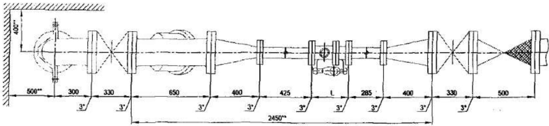
Установка комбинированного счетчика с диаметром основного канала  $D_y=80$  мм
