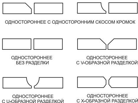
Рис. 6 Виды стыковых соединений
