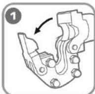
1 Отведите замок-фиксатор, откиньте неподвижное лезвие ножниц.
