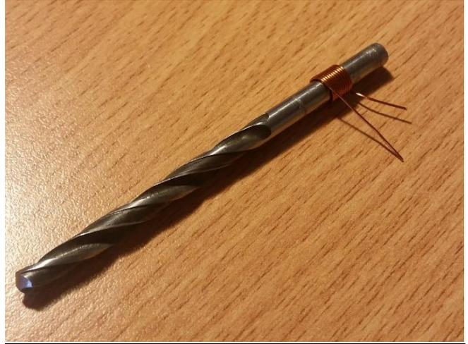
3. Снять намотку с оправки и убедиться в симметричности и равномерности конструкции. Сделать вторую намотку L2.
