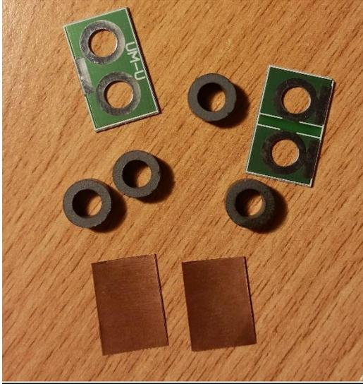
2. С помощью любого стержня диаметром 5.0-5,5мм (можно взять обычное сверло на 5-5.5мм) согнуть фольгу в цилиндр.
