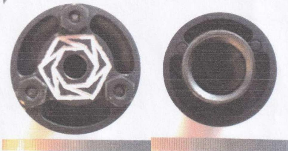
Фото №2,3. Торцевые поверхности представленного на исследовании объекта («пламегаситель Гексагон»).
