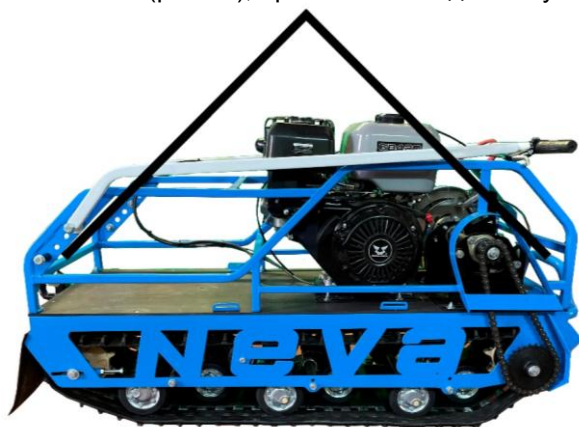
Рис.15. Схема строповки мотобуксировщика при погрузке
