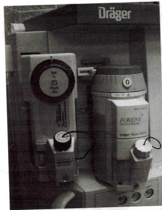
Рис. 1.3. Испарители высокого сопротивления: слева — испаритель Datum для севофлурана (Blease, Великобритания); справа — испаритель Dräger Vapor 2000 для изофлурана (Dräger, Германия)
